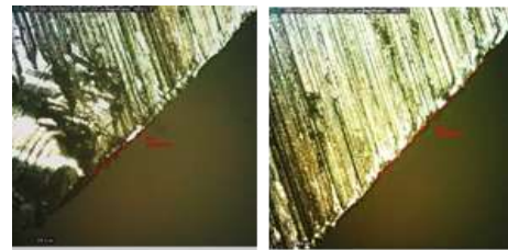
Gambar 8. Pengujian Mikro pada sudut 12° specimen 2 pada pembesaran (189) (1= DL0= 622.994 um dan 2= DL0= 1666.836 um ) Sumber: Hasil uji lab mikroskop keausan
