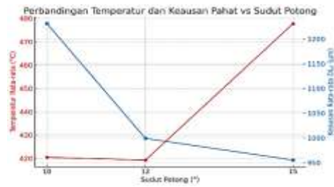
Gambar 5. grafik perbandingan temperatur dan keausan pahat pada setiap sudut potong
