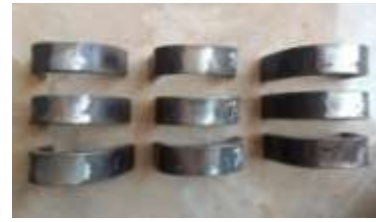
Gambar 12. Hasil Pengujian Bending Variasi Arus 90 A, 100 A, 110A
