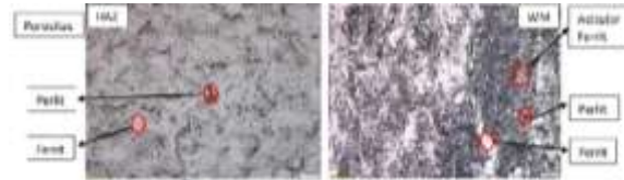
Gambar 10 Struktur mikro sambungan las arus 110 A
