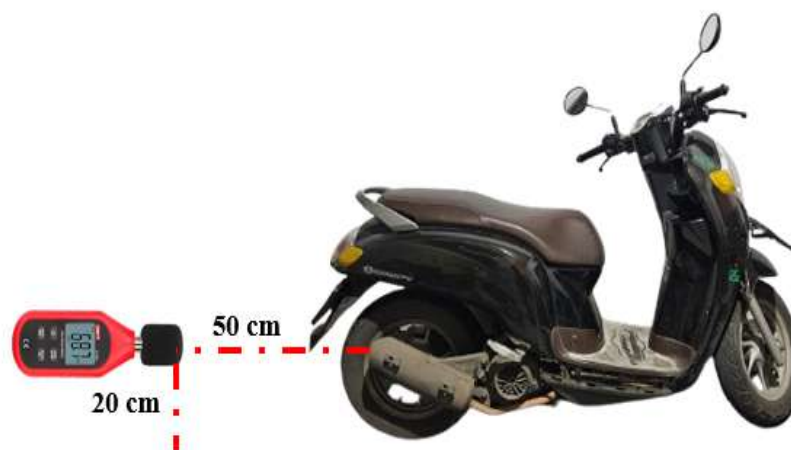
Gambar 3. Ilustrasi pengujian kebisingan.
