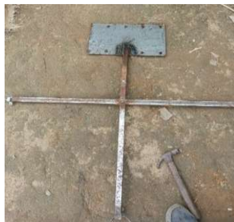
Gambar 9. Proses Pembuatan Alat Uji Gaya Dorong
