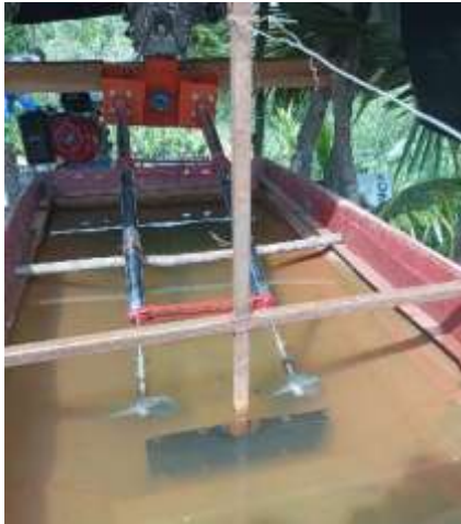
Gambar 10. Tempat Dan Alat Uji Type Twin
